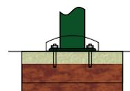
elemento para atornillar en hormigón (ver manual de instalación)
