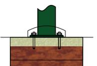
elemento para atornillar en hormigón (ver manual de instalación)
