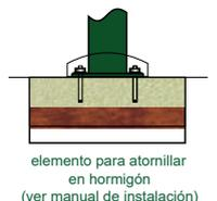
elemento para atornillar en hormigón (ver manual de instalación)
